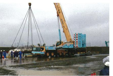
2015年9月、北九州空港沖で発見され、刈田港に引航されたクジラの死骸の撤去風景。クジラの体長は16.3m、重量は33t。これを載せるための架台が20トン。計53トンという重さを吊り上げるべく、小山が所有する400トン大型クレーンが投入された
